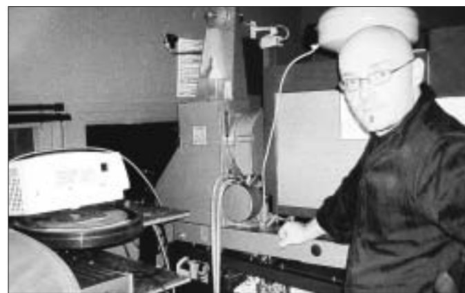
Le projecteur vidéo à gauche se substitue à la machinerie du 35 mm.
